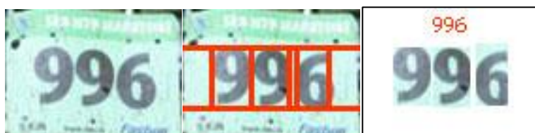
6.5.1. att. Numura atpazīšanas bibliotēkas pielietojums a - segmentētā plāksne, b – segmentēta numuru josla, c – segmentēti un atpazīti simboli
