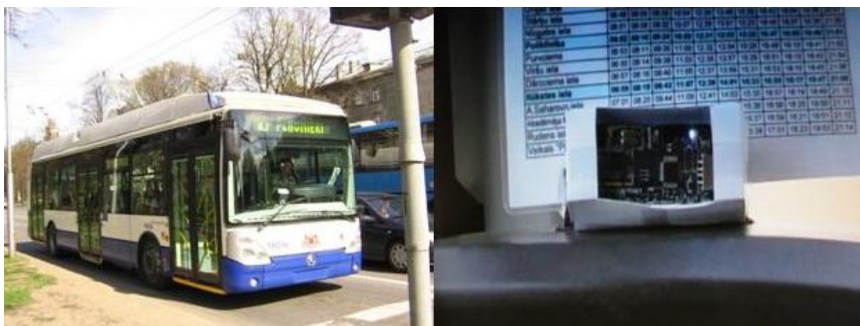
3.4. att. Testēšana. Trolejbuss ar sensoru mezglu.
