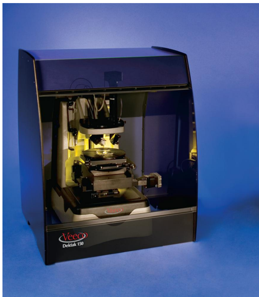
2.2.1. att. Profilometrs Veeco Dektak 150. [5]
