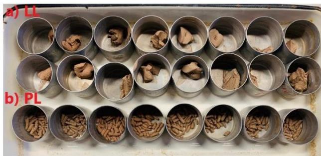
5.5. attēls. a) Plūstamības robežas noteikšanai izžāvētie paraugi; b) Plastiskuma robežas noteikšanai izžāvētie paraugi (autores foto).
