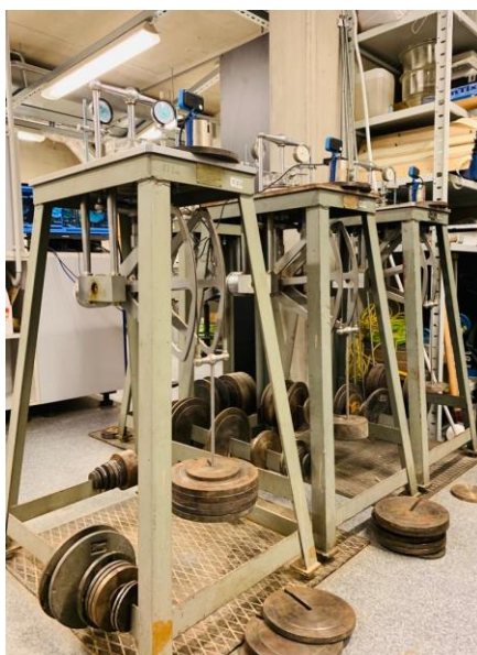
5.6. attēls. GOST VЭPM3 Hidroprojekta oedometra iekārtas (autores foto).
