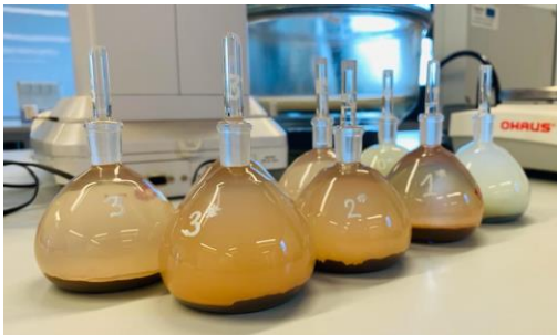
5.3. attēls. Piknometri ar paraugu pēc testēšanas (autores foto).
