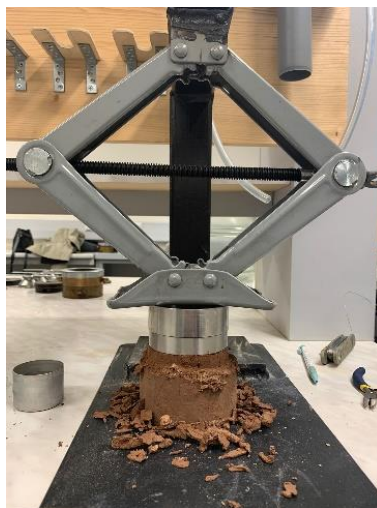
5.9. attēls. Parauga iegūšana gredzenā ar vertikālās spiedes palīdzību (autores foto).
