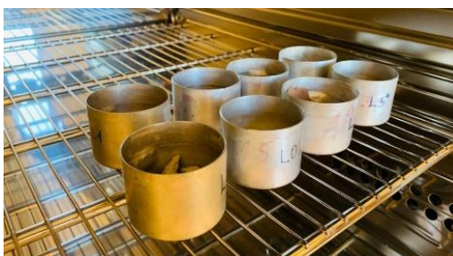
5.2. attēls. Ūdens saturs noteikšana paraugiem (autores foto).
