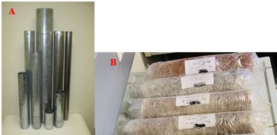
5.1. attēls. A) Shelby plānsienu paraugotājs (Diedrichdrill.lv .. S.a.); B) 4 seržu intervāla paraugi, kas atbilst 1.kvalitātes klases paraugiem (autores foto).
