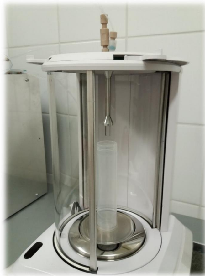
2.2. att. Gravimetriskā atšķaidītāja dozēšanas galviņa
