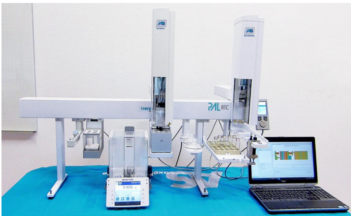
1.4. att. “ PAL RTC ” gravimetriskais atšķaidītājs viskozām vielām [18]
