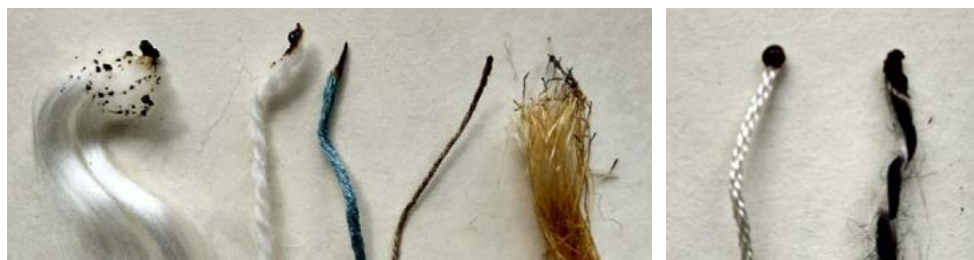
1.48.–1.49. attēls. Dabiskā zīda, vilnas, kokvilnas, lina, sizala, poliamīda un akrila izskats pēc liesmas nodzēšanas. Foto: M. Urdziņa-Deruma
