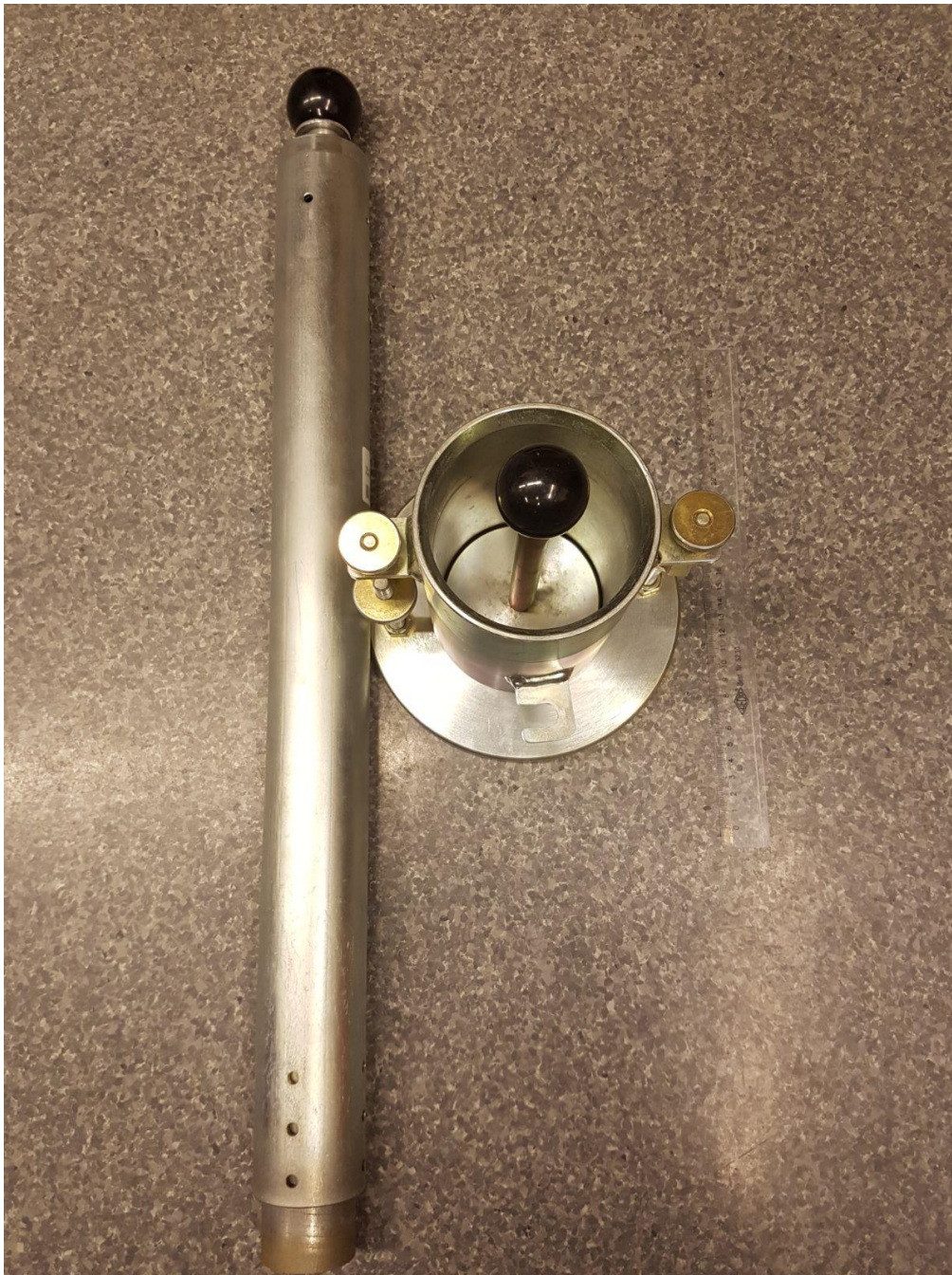
4.2. attēls. Modificētās proktora analīzes komplekts – āmurs ar masu 4,54 kg, veidne un tās pagarinājums uz augšu.
