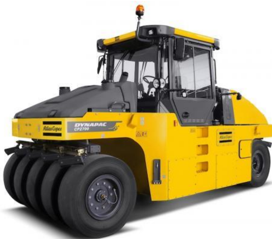
2.2. attēls. Pneimatiskais veltnis (Construction Equipment 2015).
