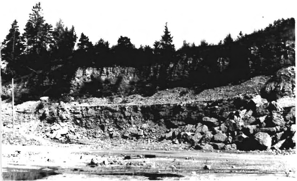
5.att. Daugavas svītas atsegums Rīteru dolomīta atradnes karjerā: apakšējā ieguves kāple - Daugavas svītas apakšējā pasvīta; augšējā (daļēji aizaugusī) ieguves kāple - Daugavas svītas augšējā pasvīta.
