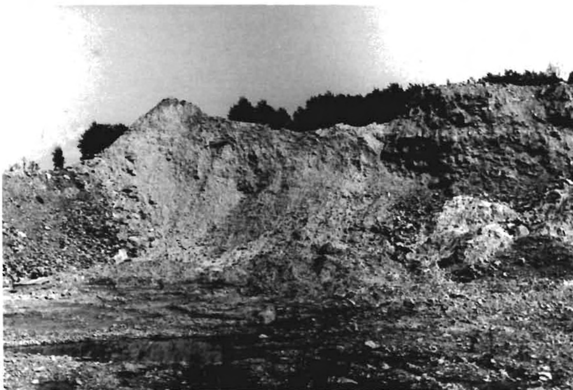
13.att. Biržu dolomīta atradnes karjerā atstāto karsta iegruvumu palikšņu iežu (gaišākie) un nesadēdējušo mehāniski izturīgo dolomītu (tumšākie labajā pusē) kontakts.
